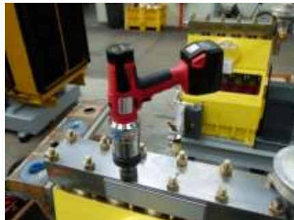
Łączenie śrubowe na głowicy pompy wysokociśnieniowej; ADS 75; M 24
