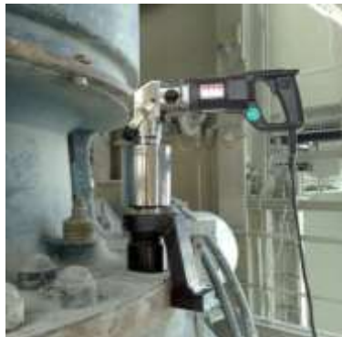
Kruszarka stożkowa z typem EDSw i standardowym ramieniem; M 48; 6,200 Nm
