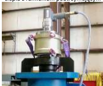
PDS 1400 w przekładni obiegowej dla zastosowań w łodziach podwodnych z ramieniem reakcyjnym TWIN.
