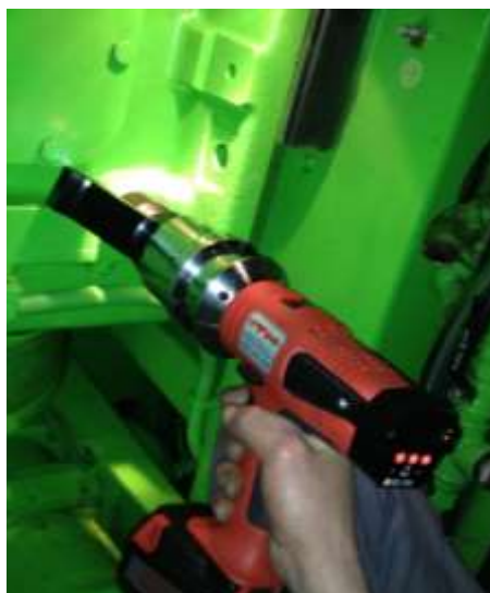
Łączenie śrubowe boczne w łożysku głównym silnika spalinowego; M 30; 1,800 Nm
