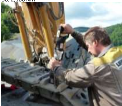
Łączenie śrubowe systemu gaśnicowego maszyn do robót ziemnych: EDS 400; 2 x M 20; 3,600 Nm
