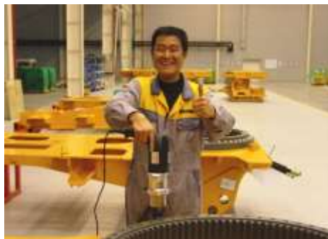
Montaż pierścienia maszyny do robót ziemnych M 30; 750 Nm
